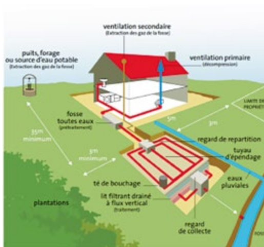
Principe de l'assainissement non collectif
