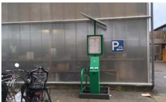
Le projet d'expérimentation vise à installer une station de (re)gonflage vélo autonome en énergie alimentée par panneau photovoltaïque et permettant une disponibilité de la charge 24/24 et des ports USB en complément. Une première phase d'expérimentation est en cours sur site privé Samoa auprès des locataires du Karting et Ecossoles, une installation sur espace public est envisagée dans un second temps en 2019.
