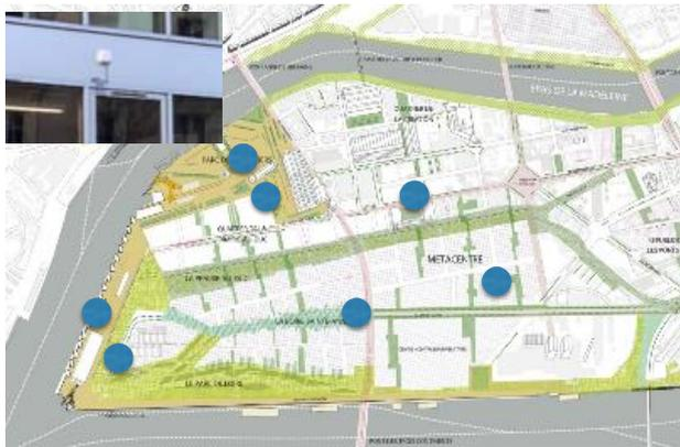
Le projet d'expérimentation vise à déployer sept capteurs de 2<sup>e</sup> génération sur les sites Samoa permettant de mesurer en continu : température, humidité, polluants et dB (niveau sonore). Le pilotage, la gestion du dispositif et la visualisation des données sont proposés à travers une plateforme SaaS. Une réflexion sera apportée à « l'actionnabilité des données » pour la création de nouveaux services.
